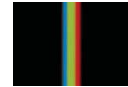
Esta aberración, basada en el mismo principio del prisma que divide la luz en un espectro coloreado, produce desplazamientos de color. Se nota especialmente en el teleobjetivo y aumenta a medida que se incrementa la longitud focal del objetivo.
