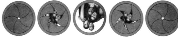
*Esquema de funcionamiento del Obturador Central*
